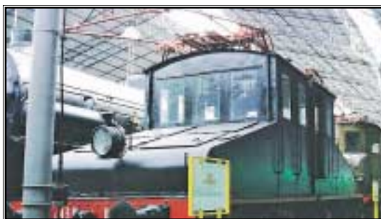
Bo'Bo'-Triebwagen: 1901: 5 Stck. RA 301-305 / später FS E 1-5, 1902: 5 Stck. RA 321-325 / später FS E 21-25, Nach 1927 von der FS teilw. entmotorisiert und zu Personenwagen umgebaut
