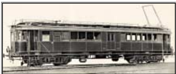
Bo'Bo'-Triebwagen: 1901: 5 Stck. RA 301-305 / später FS E 1-5, 1902: 5 Stck. RA 321-325 / später FS E 21-25, Nach 1927 von der FS teilw. entmotorisiert und zu Personenwagen umgebaut
