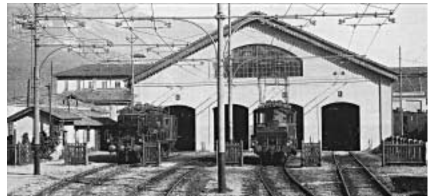
FS Deposito Lecco (am Comer See) mit E 550, E 333. Diese neuentwickelten Loktypen waren z.T. nur vorübergehend zur Erprobung auf den Veltlinstrecken eingesetzt.
